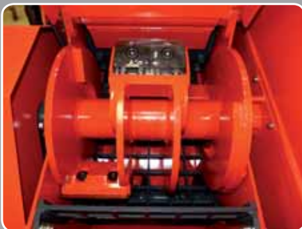
Rotor met een diameter van 600 mm, 6 messen en een grote vliegwielmassa
