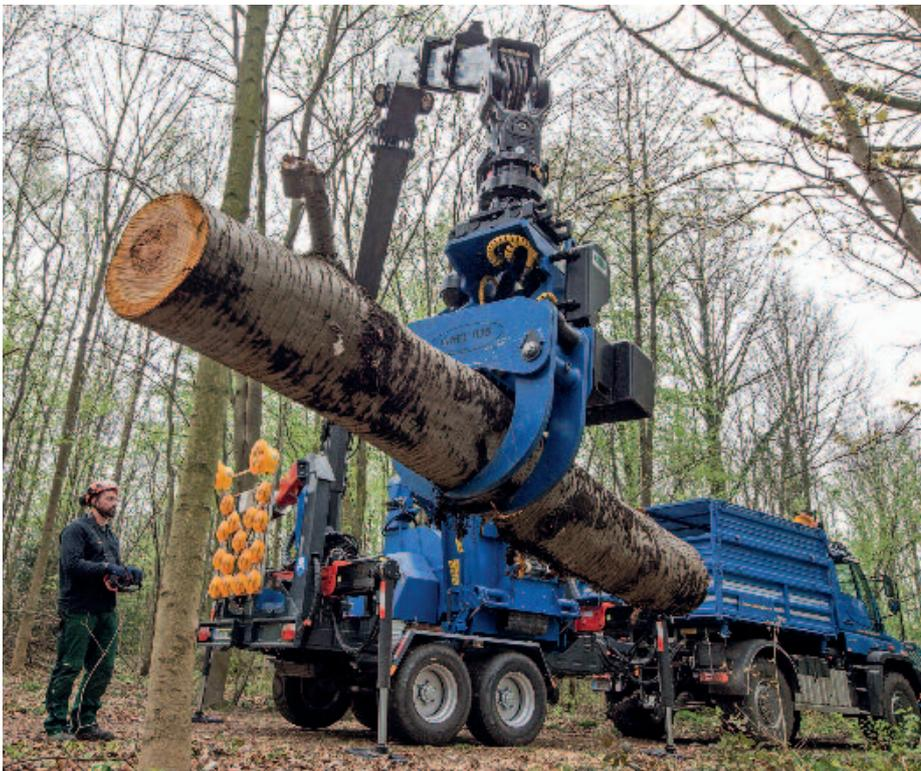
Unternehmer Schatz nutzt einen Fällgreifer GMT035 vom niederländischen Hersteller Gierkink. Dank einer 40er Schiene bewältigt das Aggregat Fälldurchmesser bis 35 Zentimeter. Die Steuerung konfigurierte Schatz selbst.
