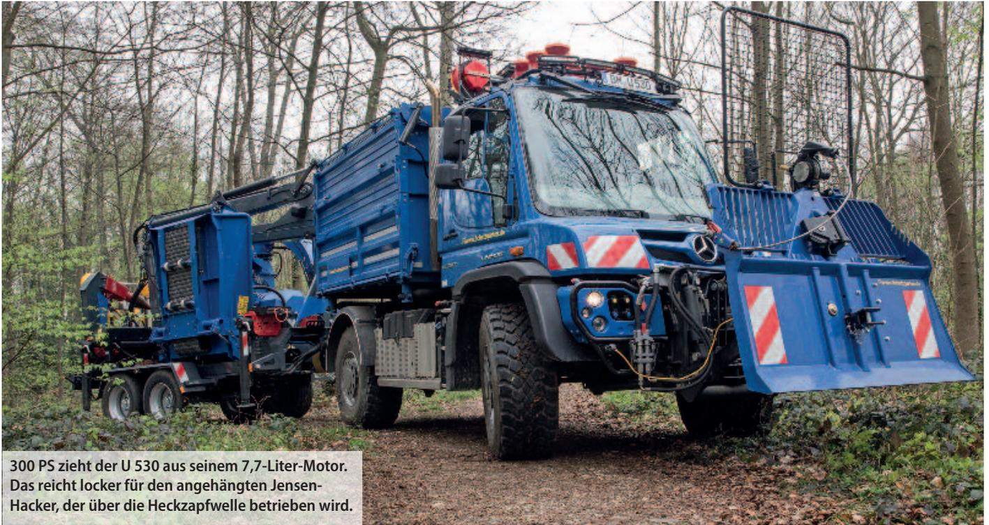
300 PS zieht der U 530 aus seinem 7,7-Liter-Motor. Das reicht locker für den angehängten Jensen-Hacker, der über die Heckzapfwelle betrieben wird.
